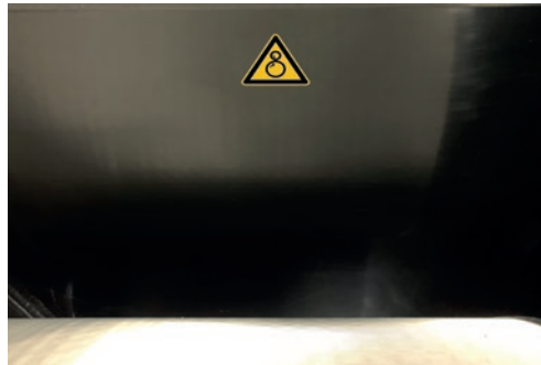
Abb. 4: Warnung vor Einzugsgefahr an der Filtertrommel
