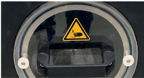
Abb. 1: Warnung vor Handverletzungen an der Abdeckung der Spülrinne
